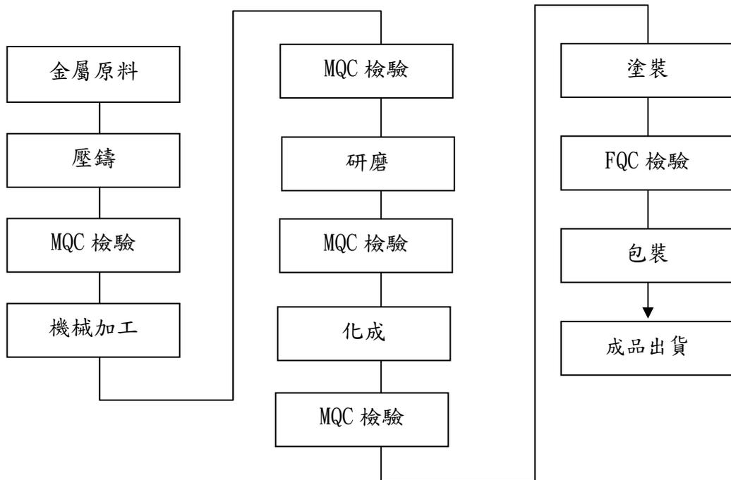
2. 散熱模組產製過程:
